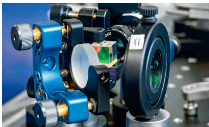
Place de mesure destinée à la caractérisation des composants à fibres optiques.
