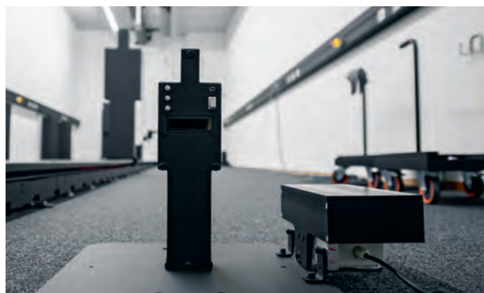
Détecteurs de mouvements et de présence pour les techniques d'éclairage au banc d'essai.
