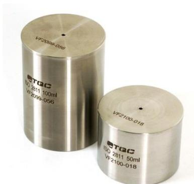
4.2 Das Einbringen des Erzeugnisses erfolgt vorzugsweise mit Hilfe eines Spachtels. Deckel und Gefäßaussenseite müssen sauber bleiben. Insbesondere beim Aufbringen des Deckels und eventuellem Austritt des Erzeugnisses durch die Öffnung ist dafür zu sorgen, dass die Deckelaussenseite gesäubert wird.
