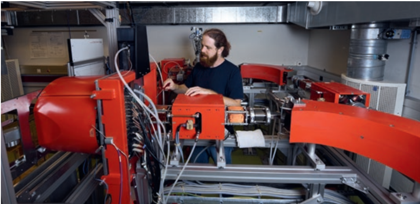
3: Mit diesem Elektronenbeschleuniger können Elektronen in Gammastrahlung verwandelt werden.
