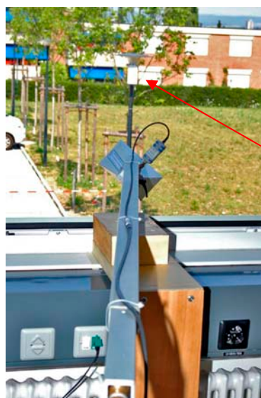
Fig. 6 Ausrichten der Hornantenne auf die Antenne mit Code 160
